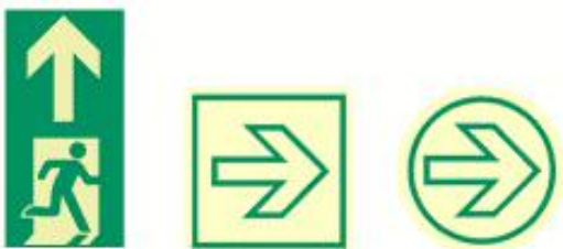
Рисунок 3 - Примеры указателей напольной разметки
